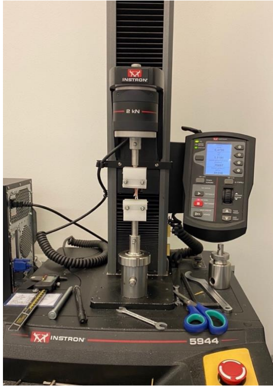
Şekil 3.9. Universal test cihazı (Instron® 5944, Norwood, ABD)
