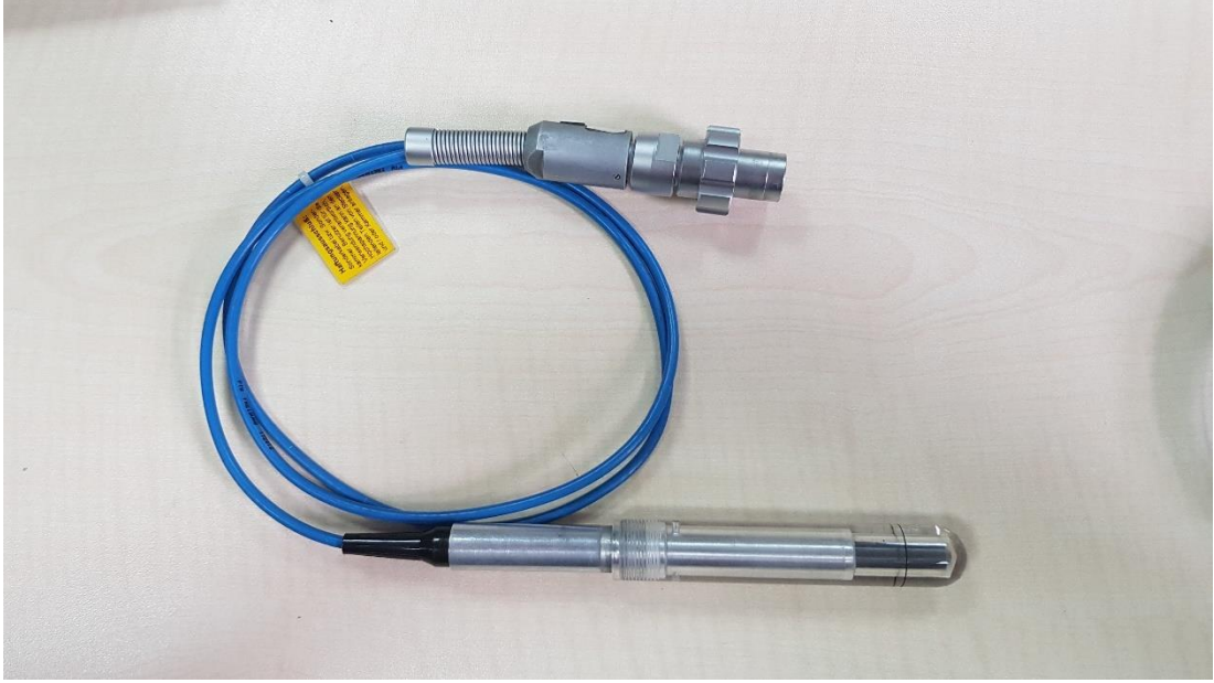
Şekil 3.3. PTW 30010 0.6 cc Farmer tipi silindir iyon odası.
