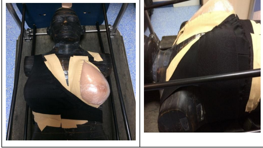
Şekil 3.14. Üretilen sütyenin Alderson Rando fantom üzerinde önden (solda) ve yandan (sağda) görünümü
