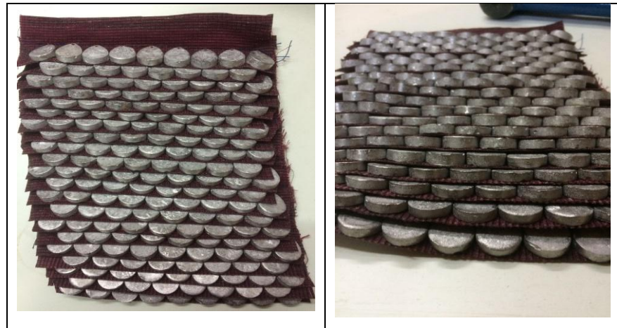
Şekil 3.19. Yapıştırma yöntemi ile üretilen zırhın karşıdan (sol) ve alttan (sağ) görünümü.
