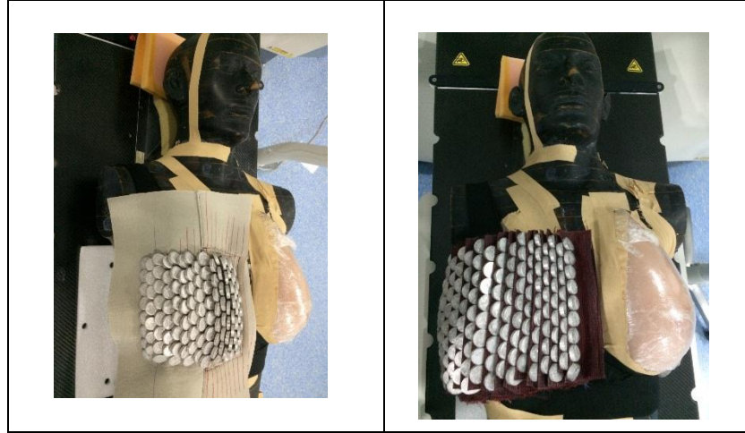
Şekil 3.20. Zırhların Alderson Rando fantom üzerinde görünümü.
