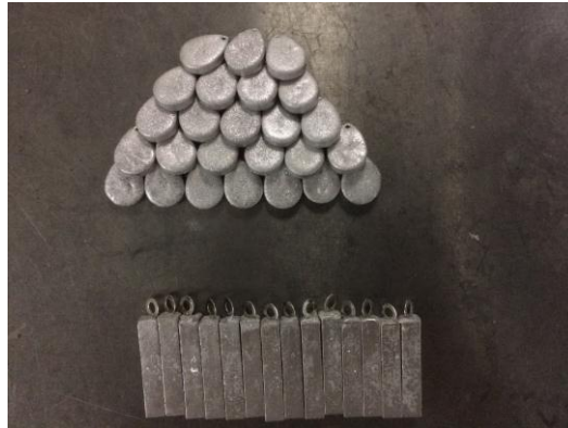
Şekil 3.16. Su damlası ve çubuk şeklinde dökülen serrobend parçalar
