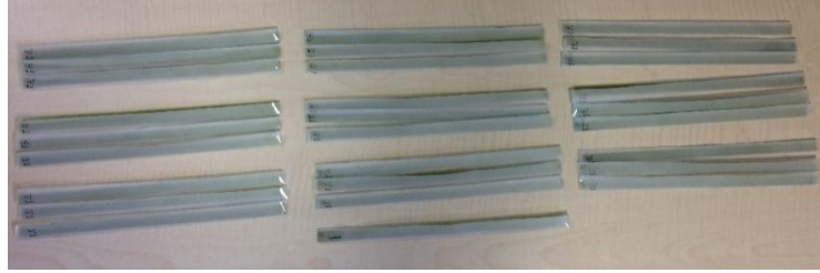
Şekil 3.26. Gafkromik filmlerin katı su fantomunda ışınlanmaları için hazırlanmaları.
