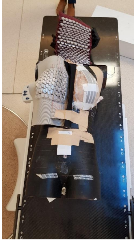
Şekil 9. Zırhlarla gafromik filmlerin Rando fantomdaki memelerin, tiroid ve abdomen bölgesinin üzerine yerleştirilmesi ve ışınlanması.
