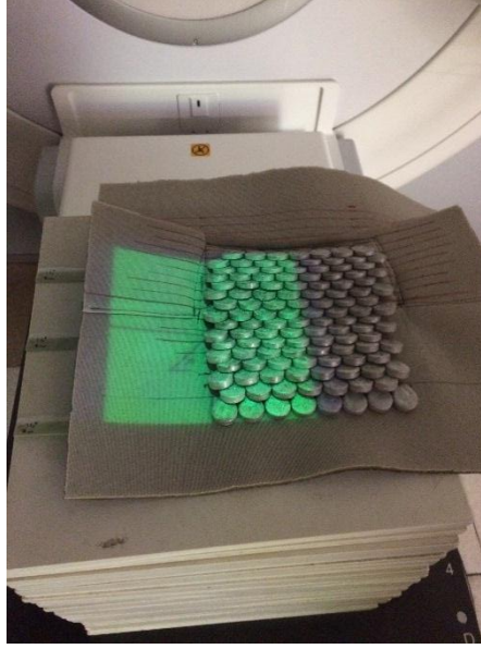
Şekil 3.30. Gafromik filmlerin 5 mm'lik zırh ile katı su fantomları arasında yerleştirilmesi ve ışınlanması.
