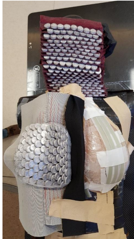
Şekil 8. Zırhlarla gafromik filmlerin Rando fantomdaki memelerin üzerine yerleştirilmesi ve ışınlanması.
