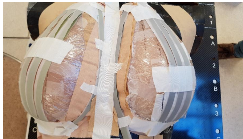
Şekil 5. Gafromik filmlerin Rando fantomdaki memelerin üzerine yerleştirilmesi ve ışınlanması.
