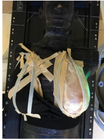
Şekil 3.35. Sütynle Gafromik filmlerin rando fantomdaki memelerin üzerine yerleştirilmesi ve ışınlanması.
