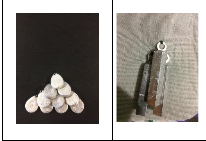
Şekil 3.17. Su damlası (sol) ve çubuk (sağ) şeklinde dökülen serrobend parçaların kumaşa dikilişi.
