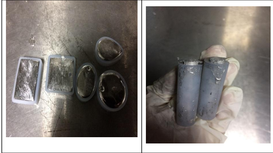
Şekil 3.15. Zırh üretimi için dökülen farklı şekillerde (solda çubuk, sağda kare, dikdörtgen, oval, daire, su damlası) serrobend parçalar
