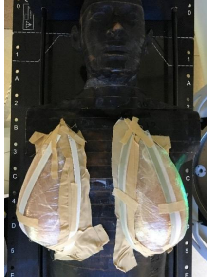
Şekil 3.33. Gafromik filmlerin rando fantomdaki memelerin üzerine sütyensiz olarak yerleştirilmesi ve ışınlanması
