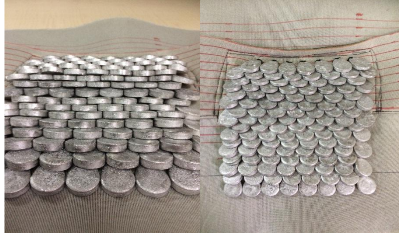
Şekil 3.18. Sütyen prototipinin üzerine konulacak su damlası şeklinde zırhın karşıdan (sol) ve alttan (sağ) görünümü.
