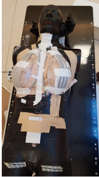
Şekil 6. Gafromik filmlerin Rando fantomdaki memelerin, tiroid ve abdomen bölgesinin üzerine yerleştirilmesi ve ışınlanması.
