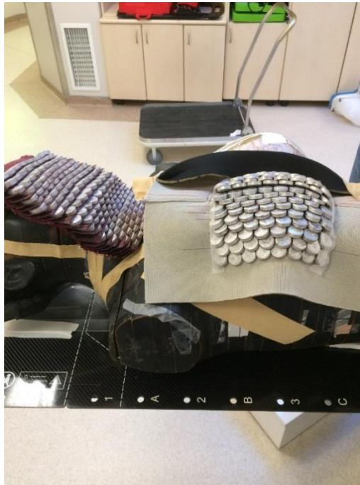
Şekil 10. Zırhlarla gafromik filmlerin Rando fantomun üzerine yerleştirilmesinin yandan görünümü.
