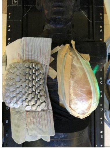
Şekil 3.36. Zırlı ve sütyenli olarak gafromik filmlerin Rando fantom ışınlamaları.
