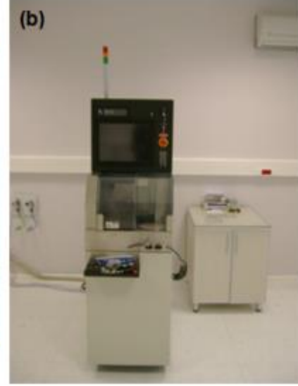
Şekil 5.2. Bilkent Üniversitesi NANOTAM'da bulunan (a) Ratalab spin kaplama sistemi ve sıcak plaka ve (b) DISCO DAD3220 yonga kesme sistemi.
