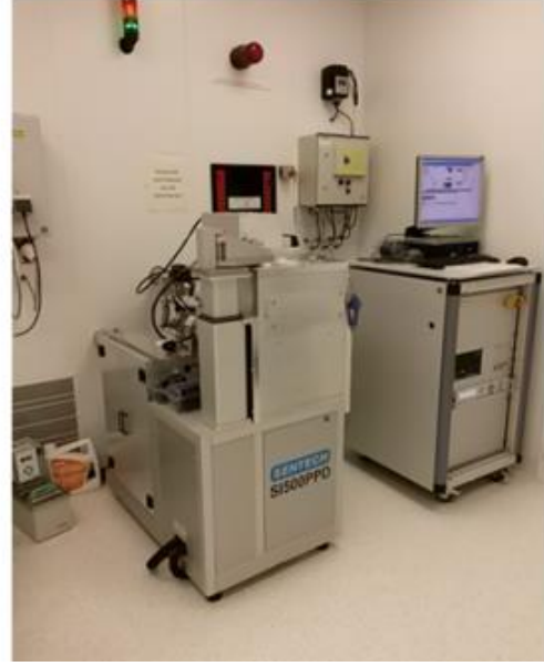
Şekil 5.13. PECVD sistemi şematik çizimi ve NANOTAM'da bulunan Sentech SI 500 PPD plazma destekli kimyasal buhar biriktirme sistemi.
