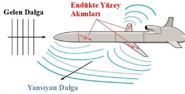
Şekil 4.4 RCS hesaplamasında MoM çalışma prensibi
