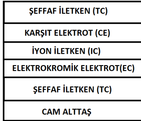
Şekil 2.1. 5 farklı katmandan oluşan bir ECD'nin şematik diyagramı [25].
