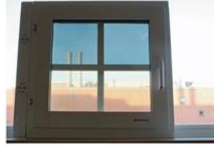
Şekil 1.1 Elektrokromizmin bazı uygulamaları a) elektronik kontrol özelliği olan mimari cam, b) Prototip elektrokromik cam.
