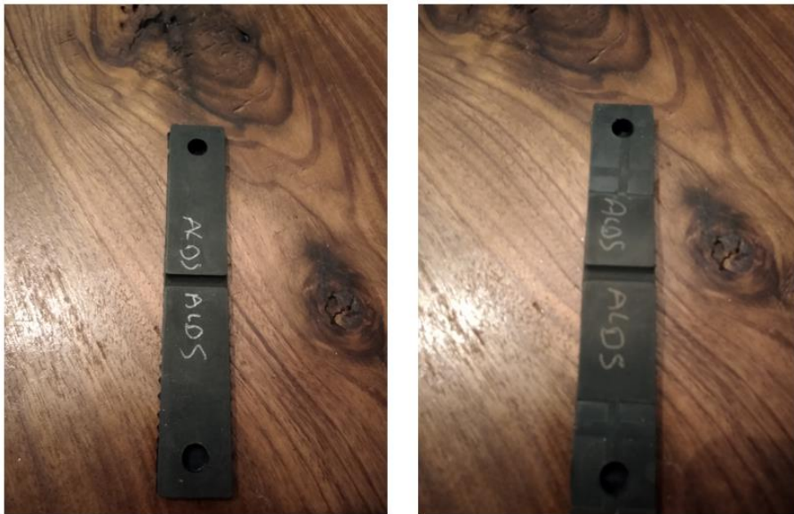
Şekil 4.32. ALDS numuneleri (sol test öncesi, sağ test sonrası)
