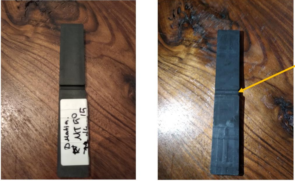
Şekil 4.33. NR MT50 numuneleri (sol test öncesi, sağ test sonrası)
