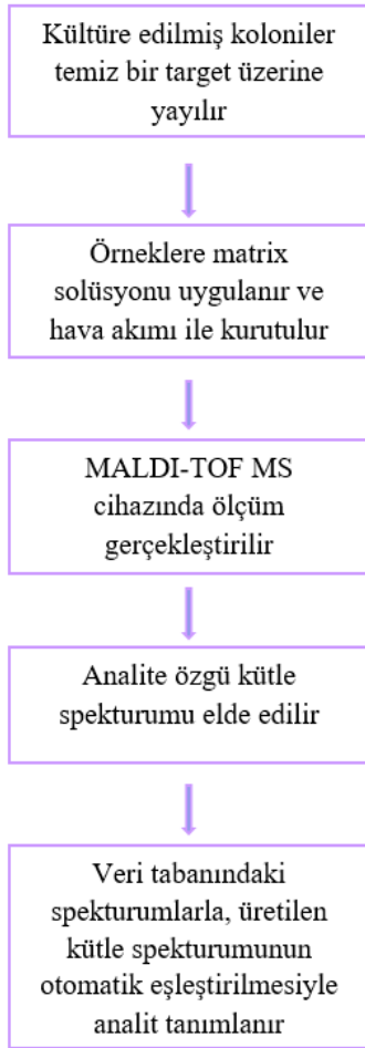
Şekil 2.1. MALDI-TOF MS ile tanımlamada işlem basamakları [45].
