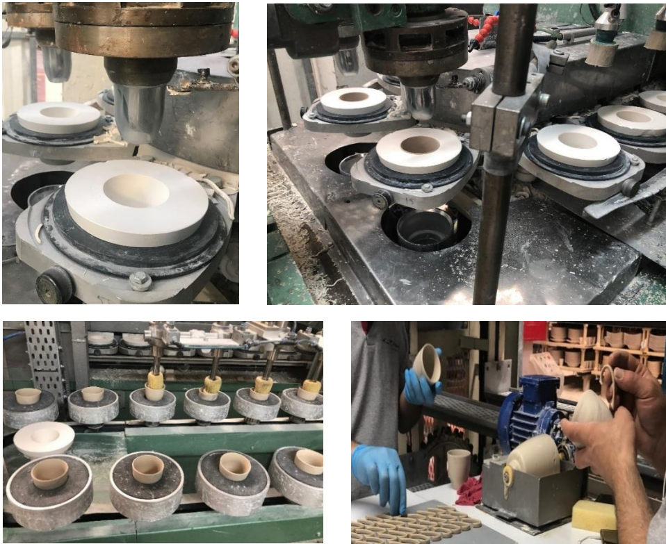
Görsel 40. Plastik şekillendirme yöntemiyle fincan üretim aşamaları. (Kütahya Porselen arşivi)
