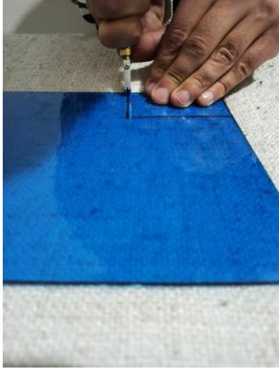
Görsel 16. Elmas uçlu cam kesici ile camın çizilmesi. (Yazarın kişisel fotoğraf arşivi)
