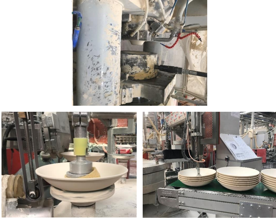
Görsel 39. İzostatik pres ile şekillendirme yöntemi aşamaları. (Kütahya Porselen arşivi)
