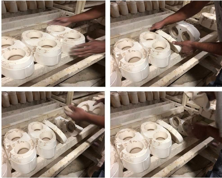
Görsel 41. Boş döküm yöntemiyle şekillendirme aşamaları. (Kütahya Porselen arşivi)
