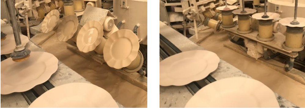
Görsel 42. Otomatik daldırma ile sırlama. (Kütahya Porselen arşivi)
