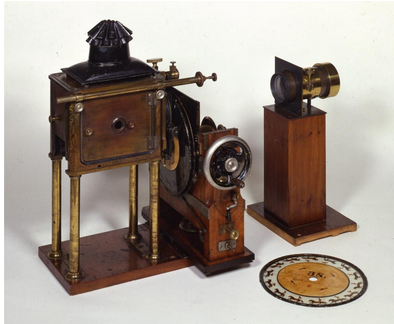
06. Görüntü: Muybridge'in 1879'da icat ettiği 'zoopraxiscope' ilk sinema gösterim cihazı olarak kabul edilmektedir.
