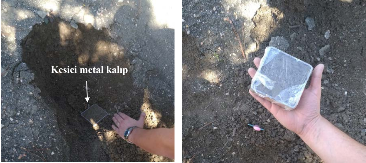
Şekil 4.8. İnceleme alanındaki yamaç molozundan kesici metal kalıpla örnek alımı.
