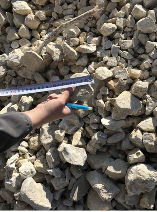
Şekil 4.9. (a) İri taneli yeni dolgu malzemesinden boyut ölçümü ve (b) fotoanaliz için dik açıda çekilen fotoğraf örneği.
