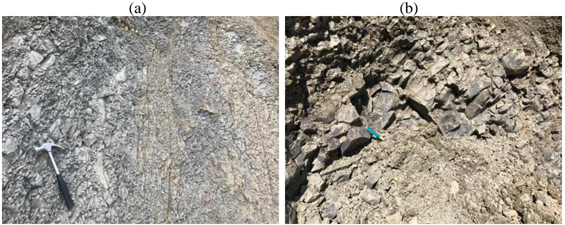
Şekil 3.4. Yenipazar formasyonuna ait marn birimlerden (a) yüzeyde ve (b) bir miktar kazı yapıldıktan sonra görünüm.
