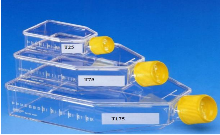
Şekil 2.3 Tek tabaka kültürlerde kullanılan T25, T75 ve T175 cm 2 flasklar [105].
