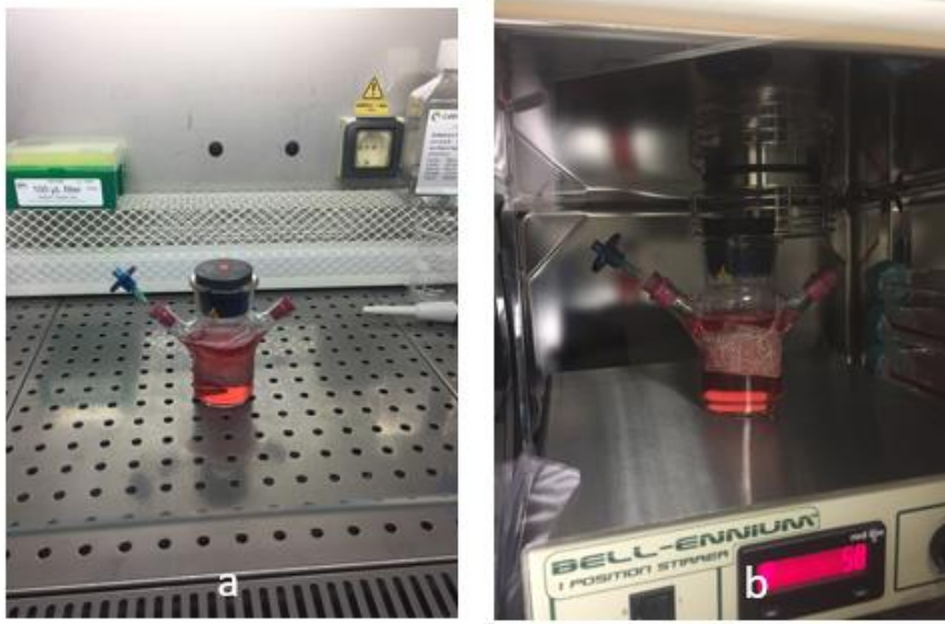
Şekil 3.4 Ekipmanları ile birleştirilmiş küçük ölçekli dolgu yatak biyoreaktör (a), kültürün başlatılması (b).
