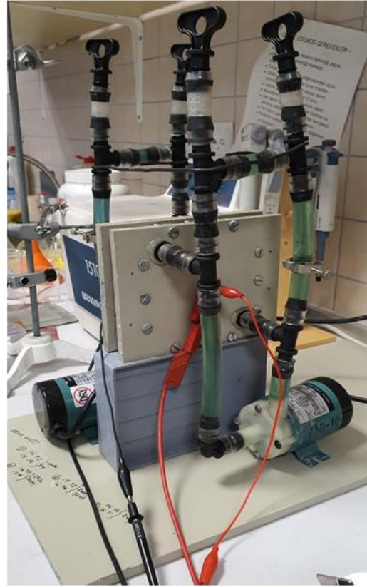
Şekil 3.4. Aside dayanıklı iki pompa ile akışı sağlanan PP tek hücre düzeneği ve bağlantıları
