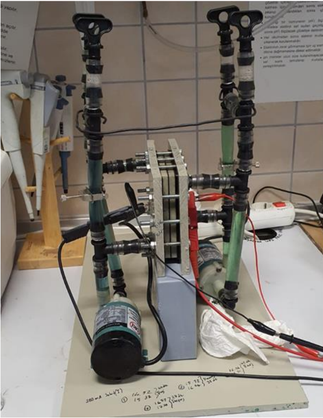
Şekil 3.4. Aside dayanıklı iki pompa ile akışı sağlanan PP tek hücre düzeneği ve bağlantıları
