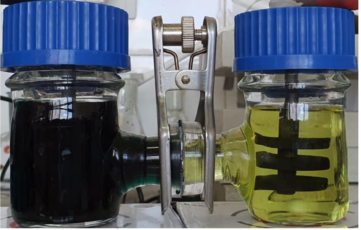
Şekil 3.3. Cam hücrede kullanılan SpGr elektrot diskleri ve hücre bağlantısı
