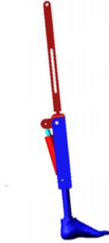
Şekil 2.5. MR sönümlendiricinin proteze yerleştirilmesi [9].
