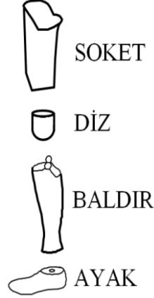
Şekil 2.1. Diz üstü bacak protezinin bölümleri.
