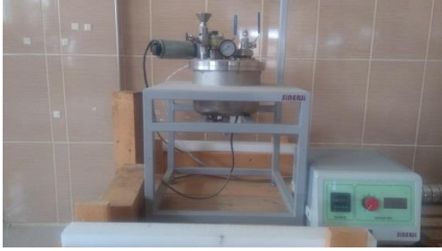
Şekil 4.1. PEI ile kimyasal modifikasyonla kompozit malzeme eldesinde kullanılan reaktör.
