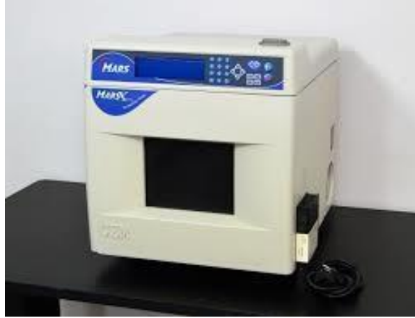
Şekil 26. Mikrodalga yaş yakma ünitesi (Microwave Accelerated Reaction System, MARS, CEM Corporation, USA)
