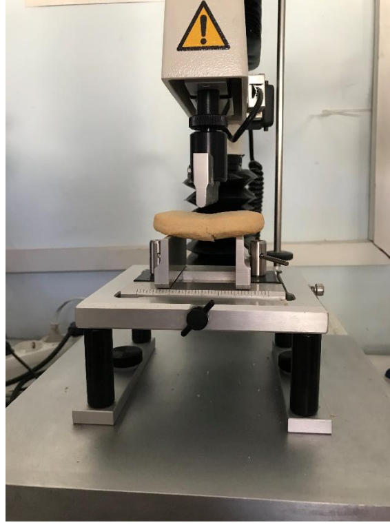
Şekil 16. Bisküvi örneklerinin tekstür özelliklerinin belirlenmesi
