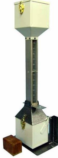
řekil 18. Kolza tohumu ile ekmek hacminin belirlenmesi
