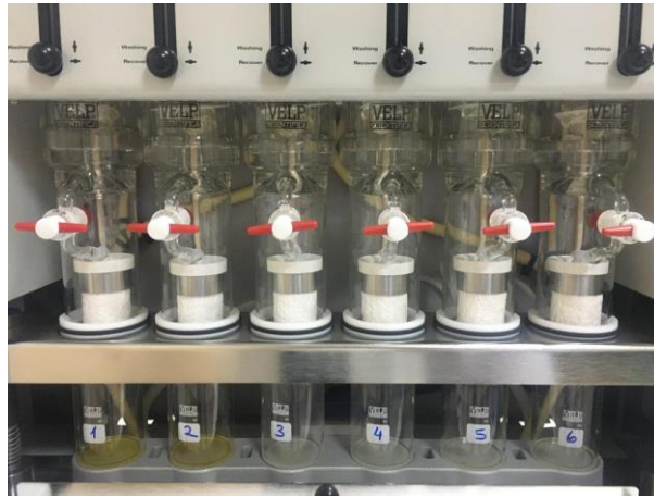
Şekil 22. Otomatik sokselet ekstraktör cihazıyla yağ ekstraksiyonu
