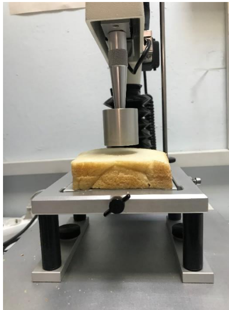
řekil 19. Ekmeklerin tekstür özelliklerinin belirlenmesi
