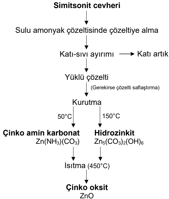
Şekil 6.1. Simitsonit cevherlerinden çinko amin karbonat, hidrozinkit veya çinko oksit eldesine ilişkin önerilen genel akım şeması.
