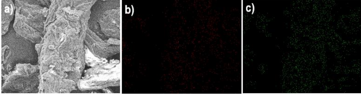
Şekil 4.25. a. saf MKS partiküllere ait SEM resmi, b. a'daki resmin kesitinde C elementinin dağılımını gösteren SEM-EDX haritası, c. a'daki resmin kesitinde O elementinin dağılımını gösteren SEM-EDX haritası.
