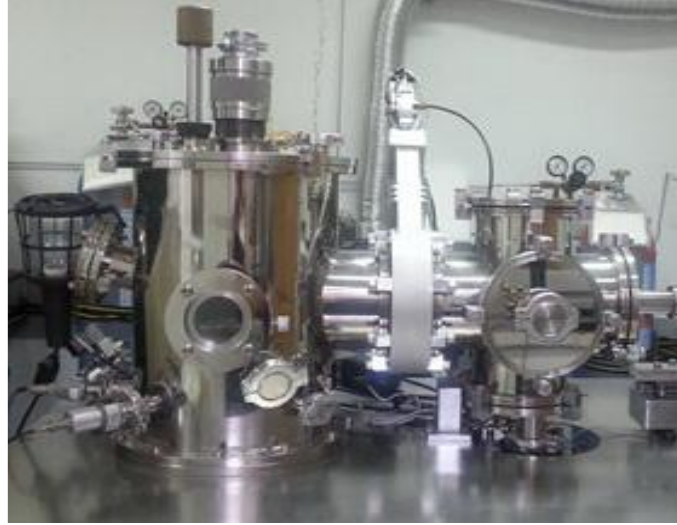
Şekil 2.9. Çift odacıklı PECVD sistemi
