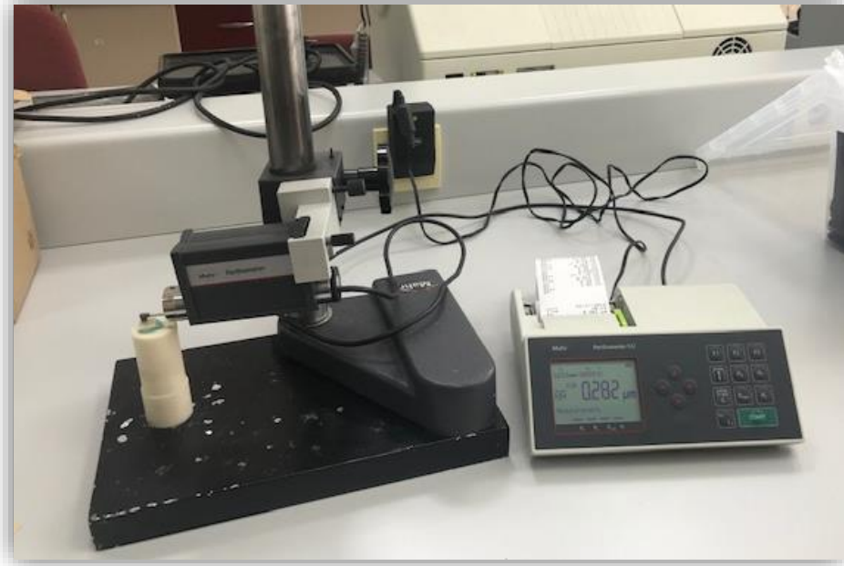
Şekil 3.14. Yüzey pürüzlülüğü ölçümünde kullanılan Perthometer M2 profilometre cihazı.
