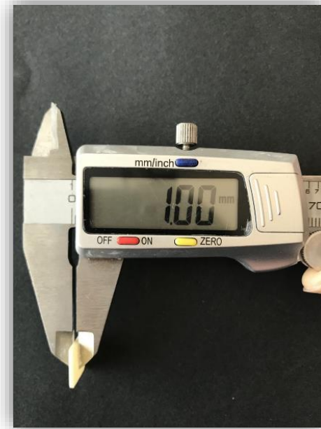
Şekil 3.12. Örneklerin boyutunun dijital kumpasla ölçülmesi.
