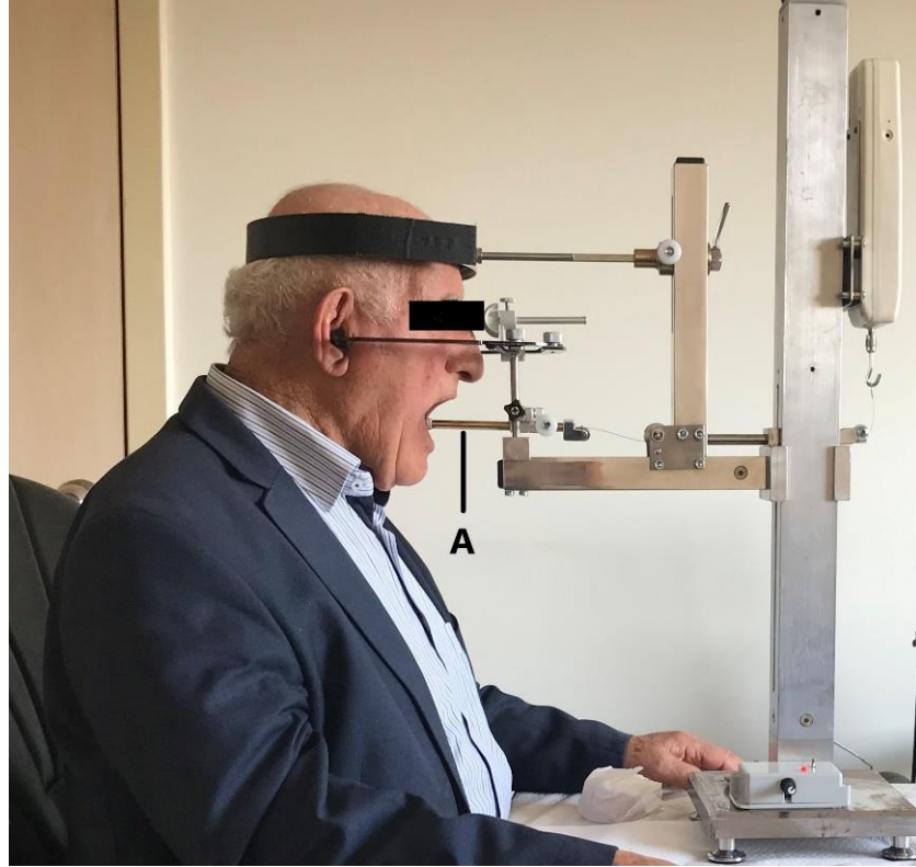
Şekil 3.12. Protez tutuculuğunun ölçülmesi; Kuvvet iletimi(A)
