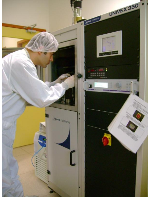
Şekil 19: Leybold Univex 350 RF magnetron saçırma sisteminin bir fotoğrafı
