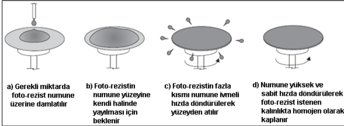
Şekil 3.11. Örnek yüzeyine fotorezist kaplanması adımı.
