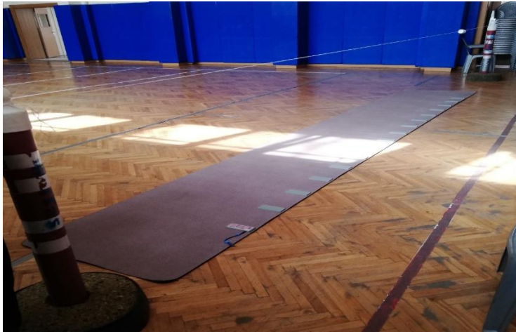
Şekil 3.2. Taktil uyarınla beraber Gaitrite Bilgisayarlı Yürüme Sistemi düzeneđi
