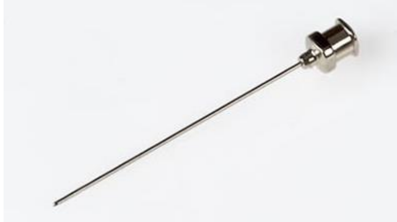
Şekil 3.1. Elektostatik eğirme işleminde kullanılan 21 gauge'lik paslanmaz çelik iğne
