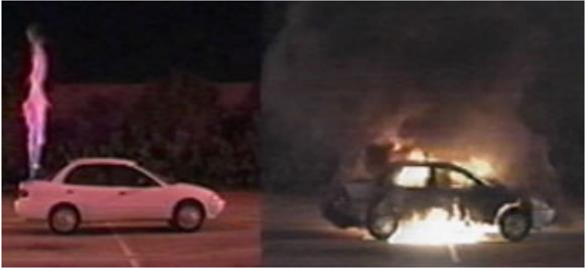
Şekil 2.3: Hidrojen (sol) ve benzin (sağ) tankı bulunan arabalarda yanma.
