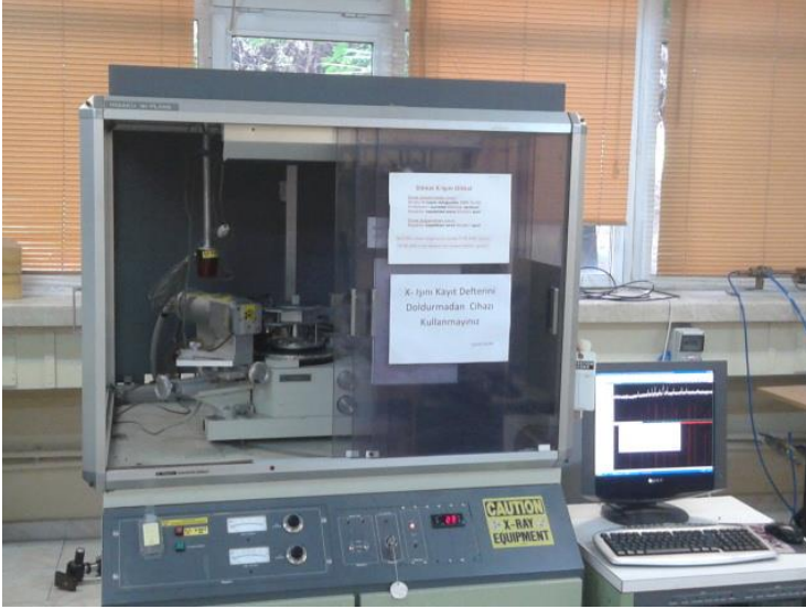
Şekil 3.5: Rikagu D-max/B X-ışını toz kırınım metresi
