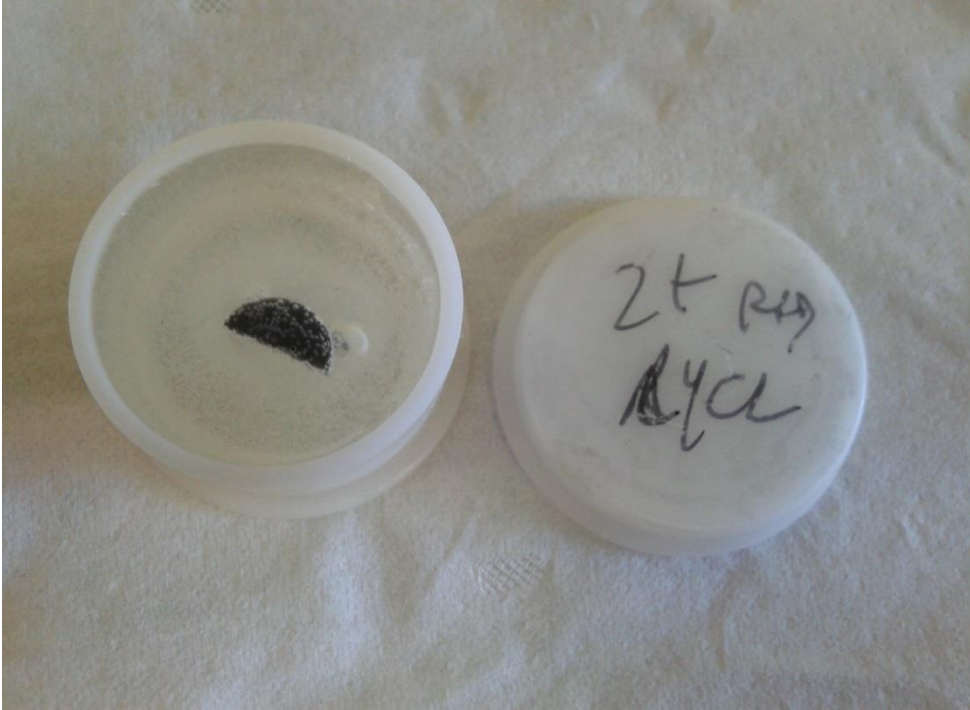
Şekil 3.8: SEM analizi için epoksiye batırılmış örnek.
