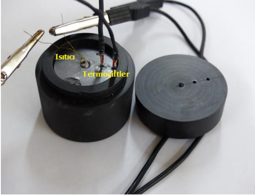
Şekil 3.14: Isıtıcı tel, termočiftler ve işlenmiş ENG peletin görüntüsü.
