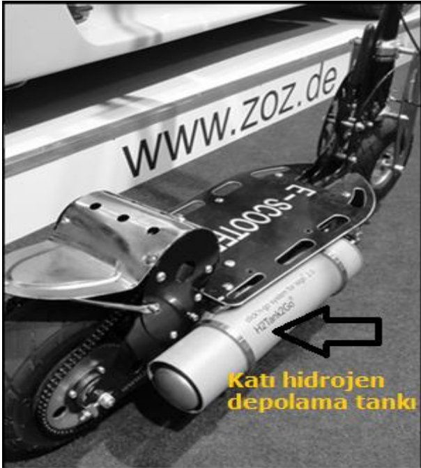
Şekil 2.3: Dünyanın ilk katı hidrojen depolama malzemesi ile çalışan mobileti
