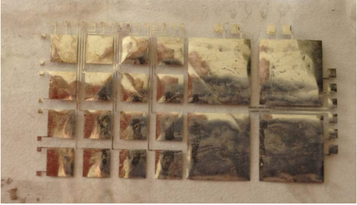
Şekil 4.7 PVDF-TrFe ince film üzerinde oluşturulan Al desenin görüntüsü
