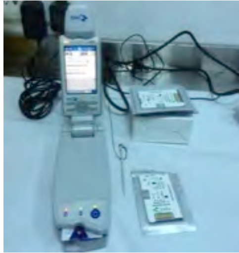
Şekil 3.5. Hayvanların kan gazı analizlerinde kullanılan portatif kan gazı cihazı.
