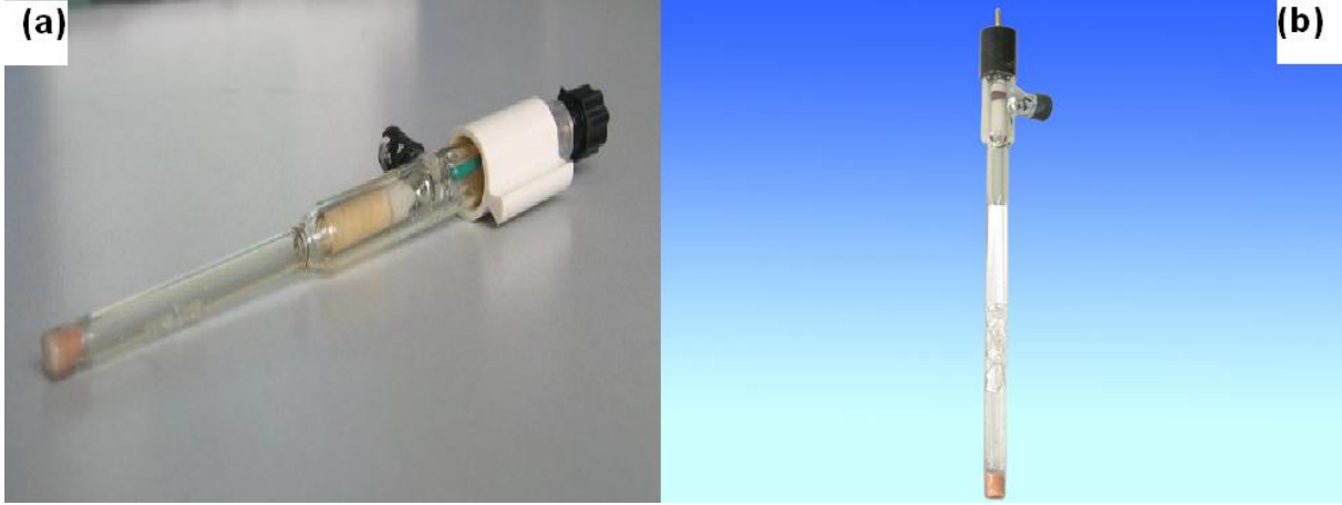
Şekil 2.6. a) Doygun Kalomel referans elektrot, b) Ag/AgCl referans elektrot
