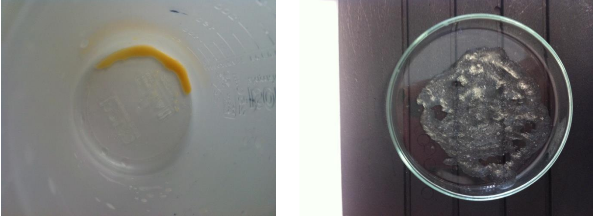
Şekil 8.32. P(AAO-VA) kopolimerinin desorpsiyon öncesindeki (solda) ve sonrasındaki (sağda) görüntüleri
