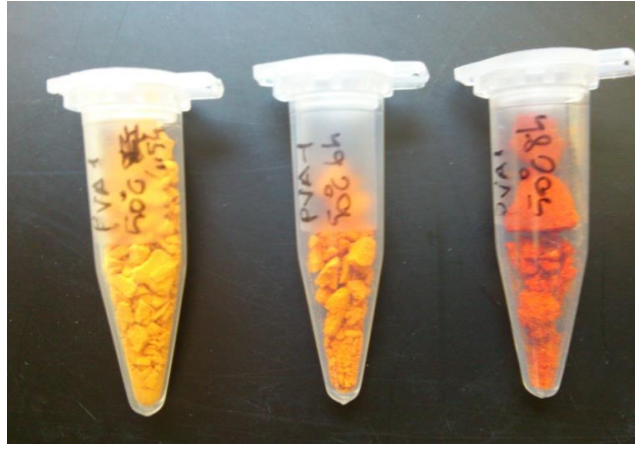
Şekil 8.3. P(AN-VAc) kopolimerinin alkoliz yapıldıktan sonraki görüntüsü; alkolizden 4.5 saat sonra (solda), 6 saat sonra (ortada), 8 saat sonra (sağda)
