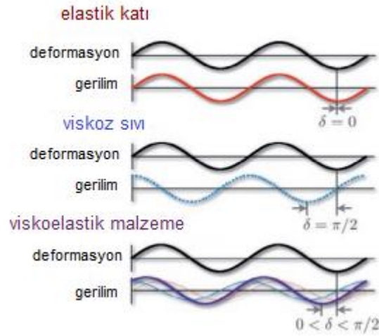
Şekil 3.3. Elastik katı, viskoz sıvı ve viskoelastik malzeme üzerine uygulanan deformasyon sonucunda ölçülen gerilimin şematik gösterimi
