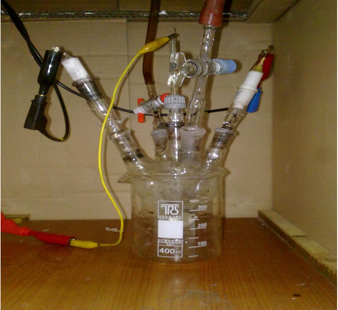
Şekil 5.1. Elektrokimyasal çalıřma hücresi
