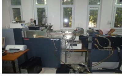
Şekil 3.5 SEBS/PP/MUM filmlerin hazırlanmasında kullanılan çift vidalı ekstrüder ve sarma ünitesi
