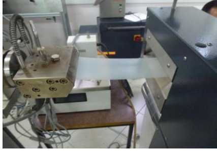
Şekil 3.6 Film hazırlama kalıbı ve sarma ünitesi
