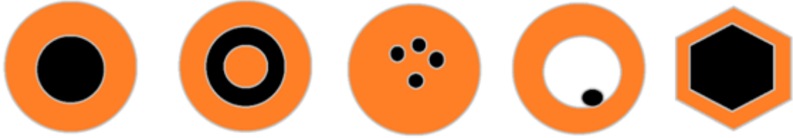
Şekil 2.14. (a) Küresel çekirdek-kabuk, (b) Nano matruşka, (c) Çoklu çekirdek-tek kabuk, (d) Hareketli çekirdek-boşluklu kabuk, (e) Hegzagonal çekirdek-kabuk şeklindeki nano yapılar [14].
