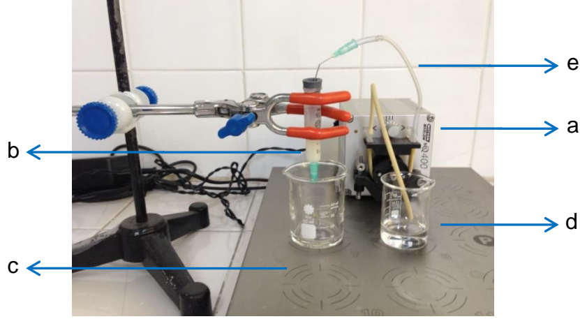
Şekil 3.3. Sürekli sistem düzeneği. a: peristaltik pompa, b: kolon, c: çözelti, d: manyetik karıştırıcı, e: silikon boru.
