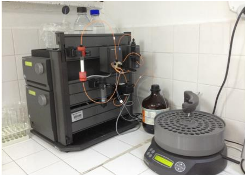
Şekil 3.4. FPLC sisteminin ve uygulanan kolonun fotoğrafı.
