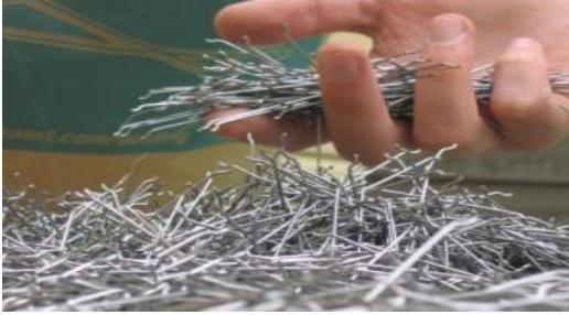
Şekil 2.11. Beksa İzmit Fabrikası dış saha yol betonlarında bir tür çelik fiber olan dramix'in kullanılması [12].
