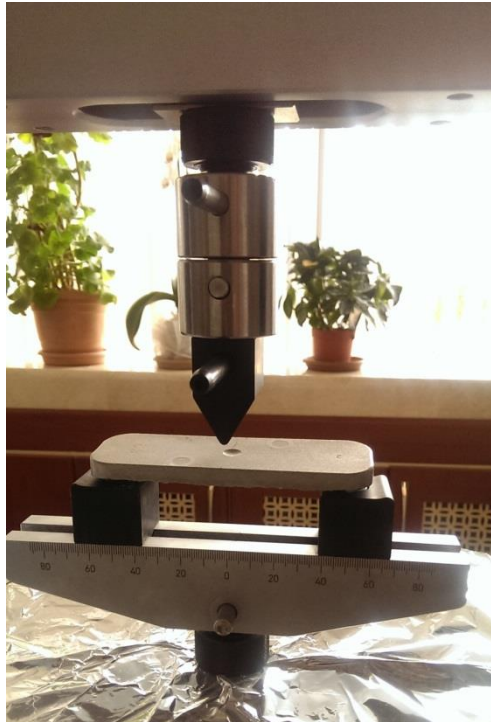
Şekil 3.4. Beton numunenin 3 nokta eğilme deneyi
