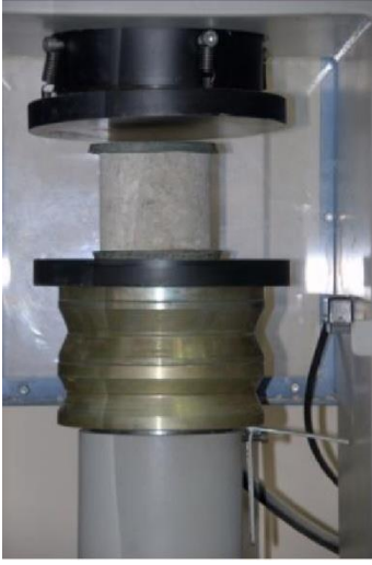
Şekil 2.2. Betonda basınç deneyi [24]
