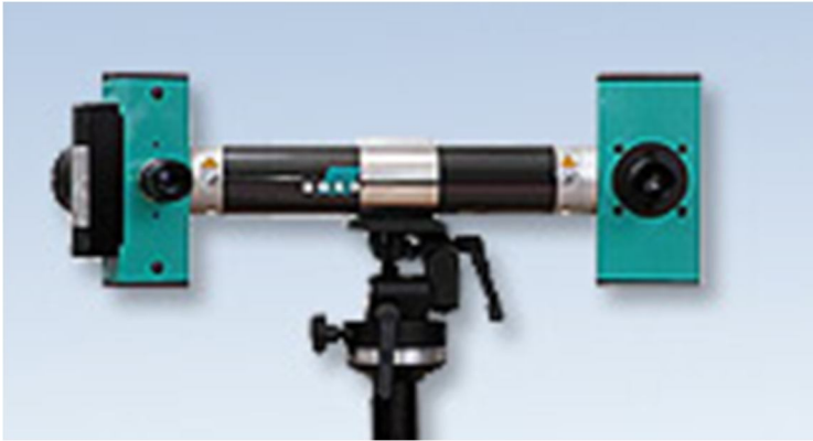
Şekil 3. 1. Breuckmann triTOS-HE (Breuckmann GmbH,Germany) yapılandırılmış ışık tarayıcı, tripod üzerine monte edilmiş kamera ve sensör modülü
