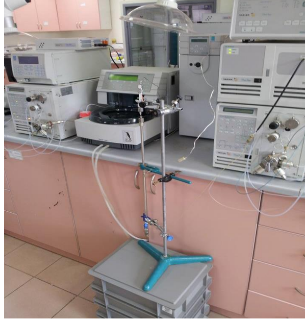
Şekil 4.4. Varian Prostar HPLC Sistemi ve ön saflaştırma işleminde kullanılan jel filtrasyon kolonu
