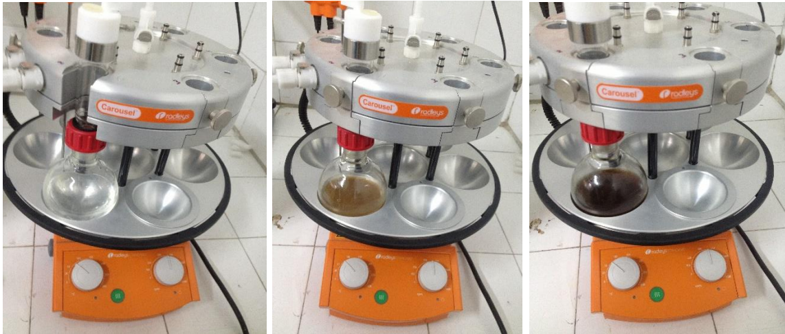
Şekil 4.1. Demir oksit nanopartiküllerin sentezi. (a) 0.7 M amonyak özeltisi. (b) Fe 3+ tuzlarının amonyak özeltisine eklenmesi. (c) Fe 2+ tuzlarının ilave edilmesi sonucu demir oksit nanopartiküllerin ökmesi.
