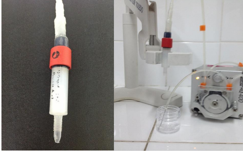
Şekil 3.5. (a) Hitrap rProtein A Sepharose™ FF kolonu (b) Serumdan Ig G uzaklaştırılmasında kullanılan deney düzeneği.
