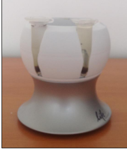
Şekil 3.3. mPGMA mikrokürelerin manyetik seperatör kullanılarak ortamdaki ayrılması.
