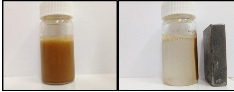
Ŗekil 4.2. mPGMA mikrokrelerin manyetik alana dođru hareketi.
