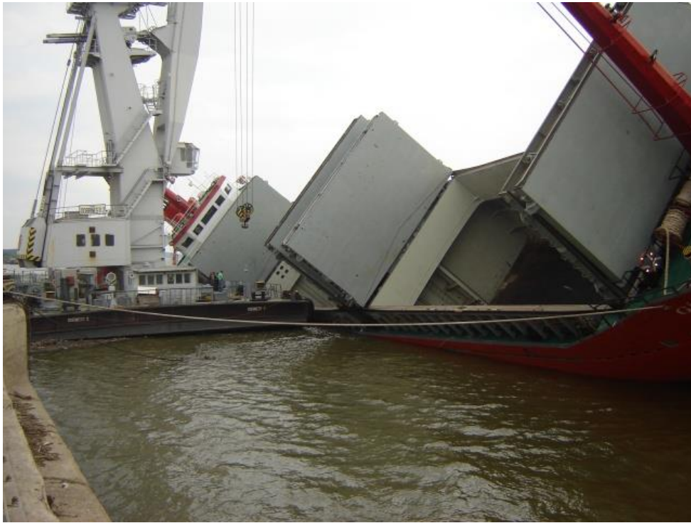
Resim 2. 4. Eylül 2006 Tarihinde Galatz Limanında Çelik Yükleme Esnasında Yük Kayması nedeniyle 60 Derecelik Yan Yatması Olayı
