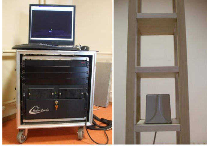
Şekil 3.19. Motion Monitor® İskelet Analiz Sistemi temel birimi (solda) ve alıcısı (sağda).
