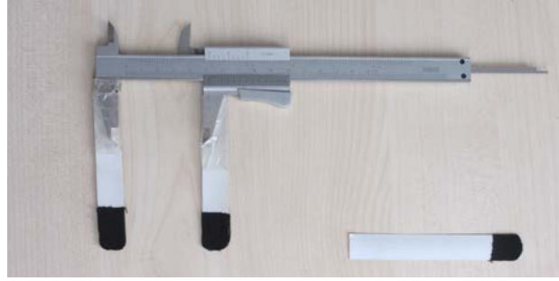
Şekil 3.2-13. Medio-lateral yer deęişim ölçümü için modifiye edilen kaliper
