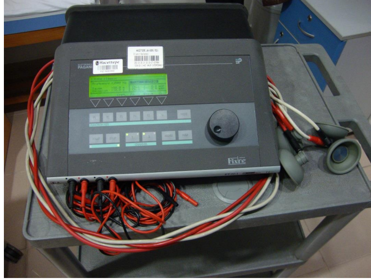
Şekil 3.2.2.1. Russian akımı uygulanan Electronica Pagani aleti.
