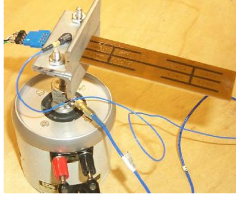
Şekil 2.5. Piezoelektrik iki örtülü enerji hasatçı (MIDE QP40N) test düzeneği [26]
