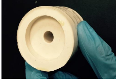
Şekil 4.1. Tek sütunlu polimer yapı üretimi için silikon kauçuk malzemeden kalıp
