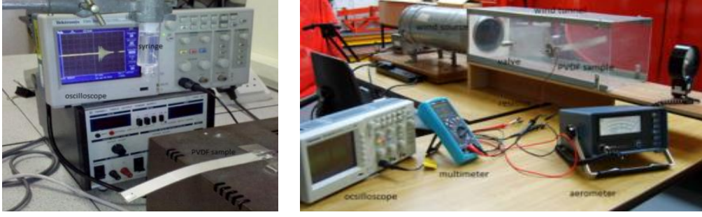
Şekil 2.15. Enerji hasadı sistemleri için yağmur ve rüzgar test düzenekleri [48]
