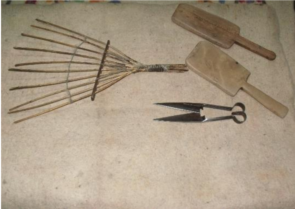
Şekil 55: İdris Çoban atölyesinde kullanılan sepki, tokaç ve makas. Balıkesir.
