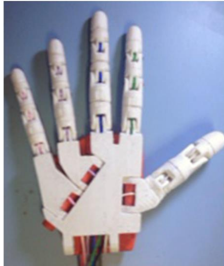
Şekil 2.9. Langevin tarafından tasarlanan [25] ve Stoppa tarafından kinematik analizi sunulan [26] INMOOV robotik eli.
