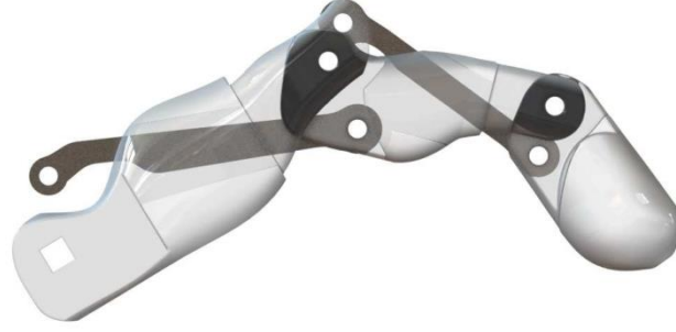
Şekil 2.1. Dört çubuklu bağlantı tabanlı eksik tahrikli yapıya sahip protez parmak modeli [16].
