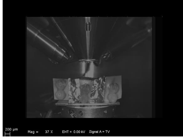
Şekil 4.6. Elektron mikroskobuna yerleştirilmiş örnekler.
