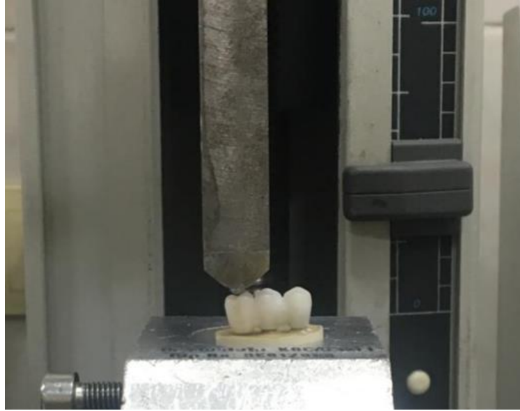
Şekil 3.16. Statik yükleme için evrensel test cihazına sabitlenmiş örnek.
