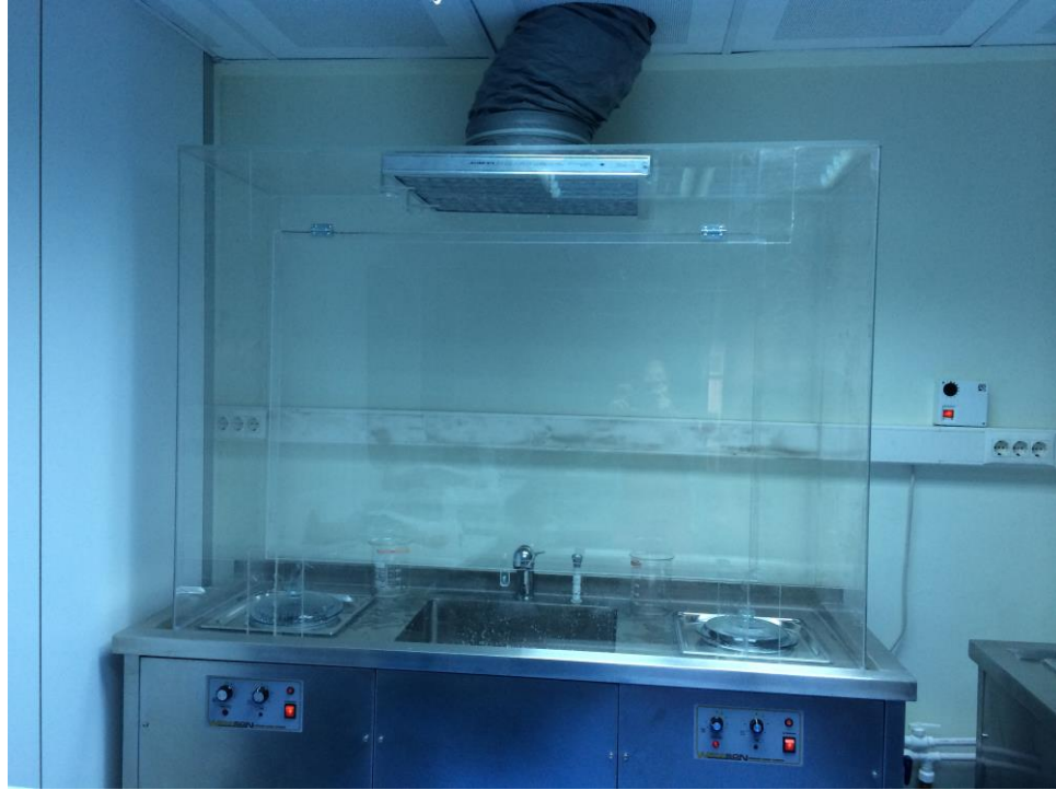
Şekil 3.7. Asitleme ve nötralizasyon işlemlerinin yapıldığı cihazlar (Wattson Yıkama Sistemleri, Türkiye)
