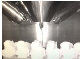
Şekil 3.11. İncelenecek yüzeylerin TEM tüpüne dik konumda yerleştirilmesi
