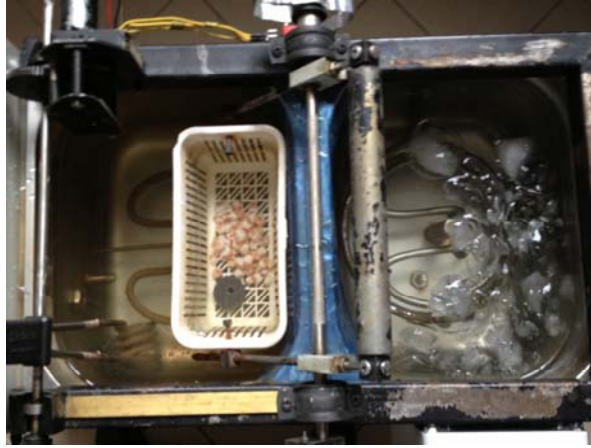
Şekil 3.12. Örneklere ısı döngü işleminin uygulanması
