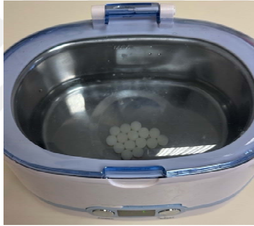
Şekil 3.7. Örneklerin ultrasonik banyoda temizlenmesi.
